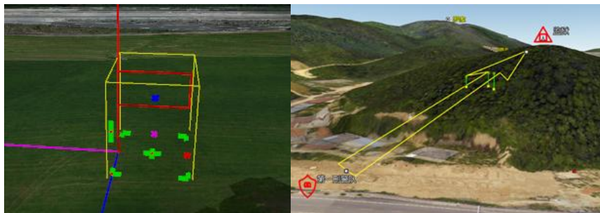
図-35 マーキング編集モード：ベクタポイントマーキング（左）ラインサーフェスマーキング（右）
